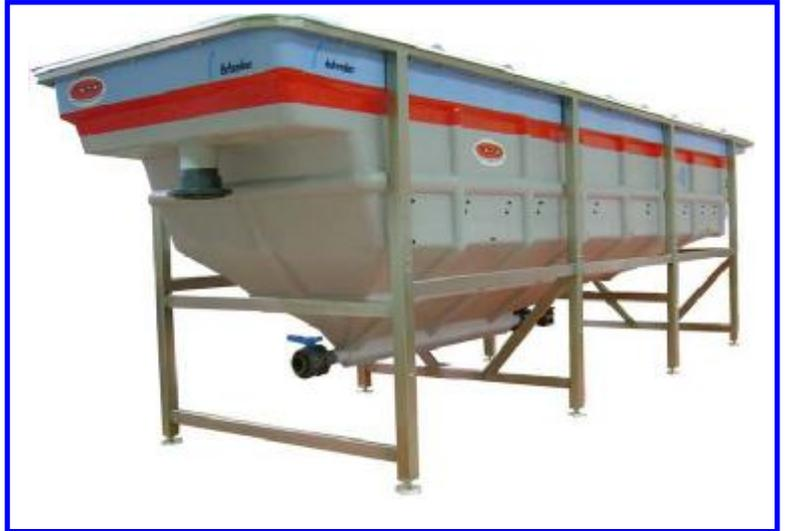
Ламельный отстойник DCL разработан для непрерывного отделения осадка и обеспечивает выполнение двух необходимых целей: увеличение площади отстаивания и создание ламинарного потока.
