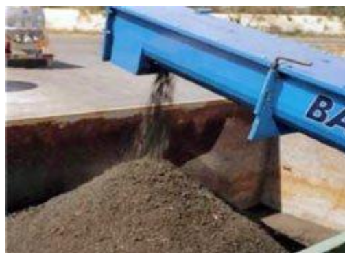
Рис. 4. Осадок, обезвоженный на декантерной центрифуге «BARGAM» Barigelli Gambetti (Италия)
