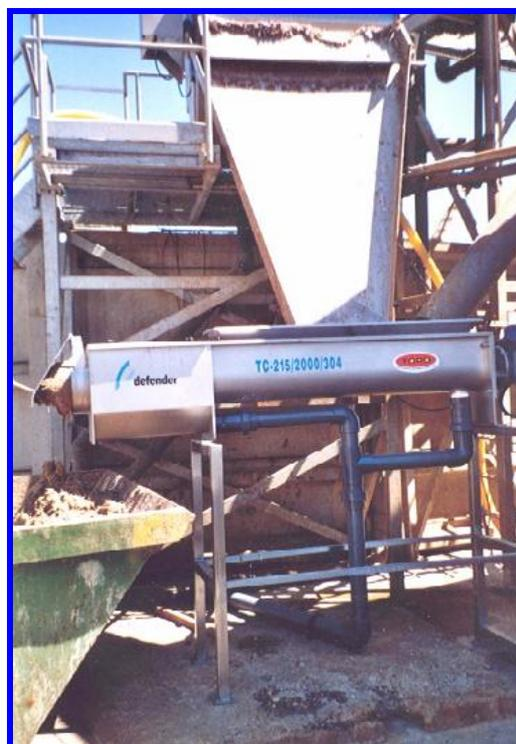
Конструкция установки исключает механический контакт ее деталей с содержащимися в сточных водах примесями, обеспечивая гарантированный длительный срок эксплуатации.
