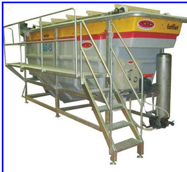
Принцип работы сепаратора жира FSG заключается в насыщении сточных вод мелкими пузырьками воздуха, которые всплывают на поверхность вместе с частицами жира (напорная флотация). Скорость всплывания пузырьков жира составляет 3-4 мм/с. При введении пузырьков воздуха в жидкую фазу создаются частицы с меньшей плотностью, что способствует их более быстрому всплыванию на поверхность.
